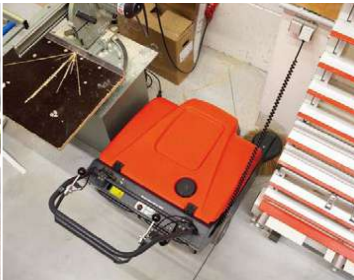
DustStop (opcional) reduz as emissões de pó e partículas finas na escova lateral em até 90%.
